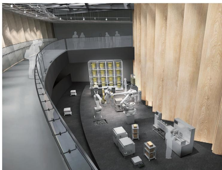
写真4 3Dプリンタ、双鶴によるツール製造
