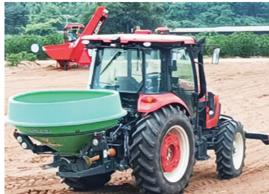
写真9 自動操舵による播種作業（左）および自動運転による施肥作業（右）のデモンストレーション 自動操舵ではオペレーターがハンドルに触れていないことを示すために両手を上げるおなじみのポーズが確認できる。無人状態で行われる自動運転を実際に目の当たりにするのは筆者らも初めてであった。
