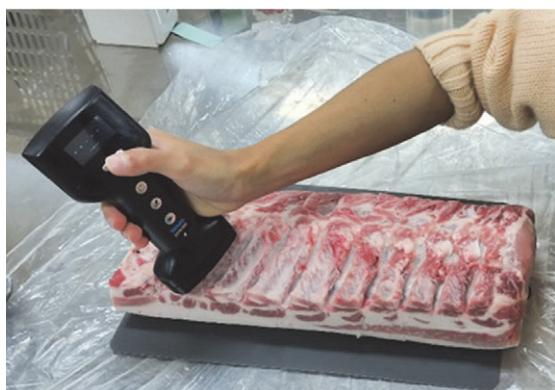
写真 Fish Analyzerでの豚ロース部分肉のインピーダンス値の測定
