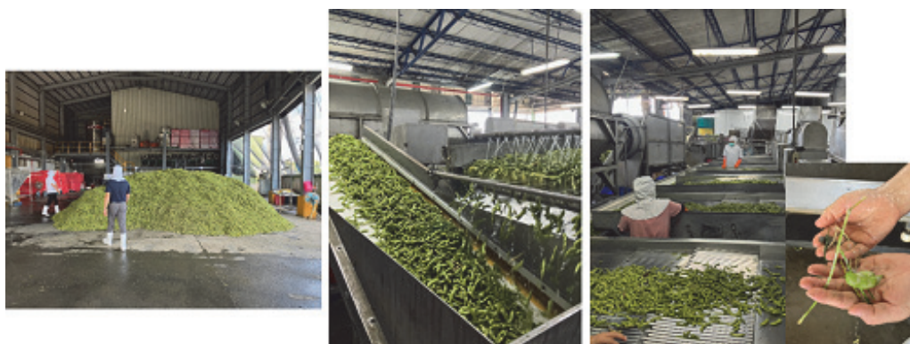
写真6 えだまめの洗浄、選別の様子（屏東県） （人の背丈ほどに積まれた原料えだまめ（左）、機械での水洗いの様子（中）、 人手による混じり物や不良品の除去作業の様子と除去物（右））
