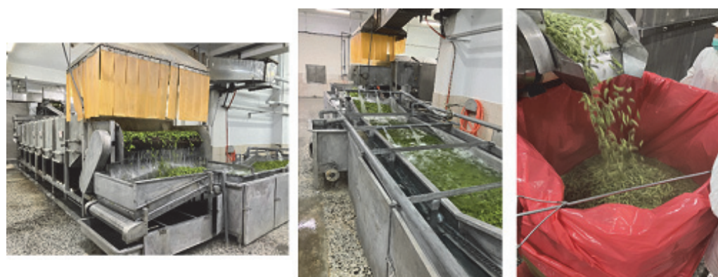
写真7 えだまめのゆで上げから冷凍までの様子（屏東県） （ゆで上げ機から出てきたえだまめ（左）、冷却水での段階的な冷却（中）、 半製品としての保管容器への格納（右））
