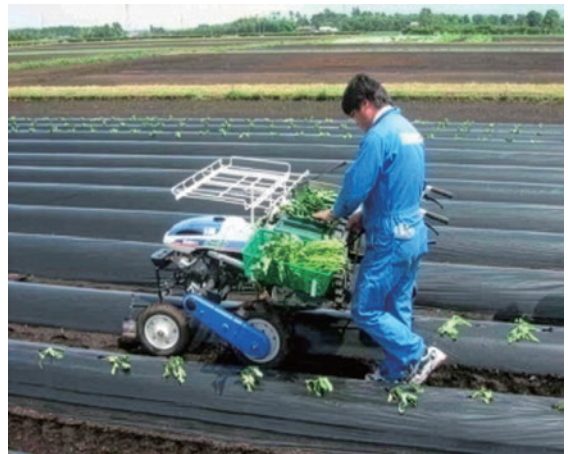
写真4 挿苗機による植え付け
