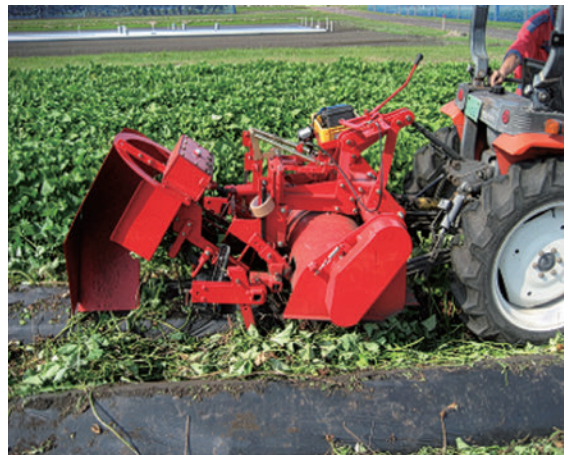
写真5 しょ梗引き抜き機による茎葉処理
