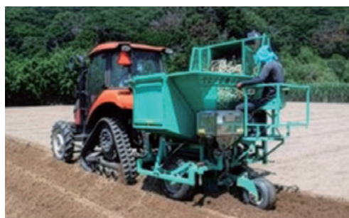
写真3 植え付け作業（左が全茎式プランタ、右がピレットプランタ）
