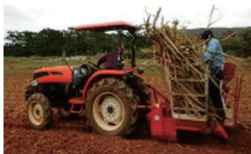
写真3 植え付け作業（左が全茎式プランタ、右がピレットプランタ）
