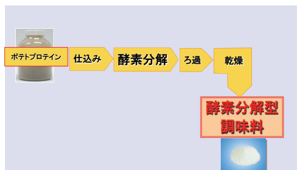
図5 ポテトプロテインを原料とした酵素分解型調味料の製造工程
