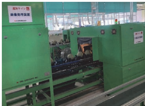
写真1 メロン選果場の内部品位センサーと画像処理装置
