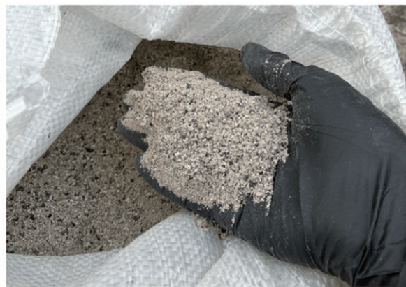
写真 牧場に導入されるサイズの家畜排せつ物減容処理設備と生成されたセラミック系粉末
