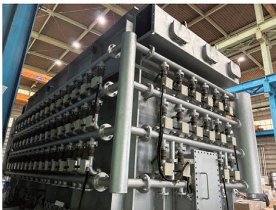
写真 牧場に導入されるサイズの家畜排せつ物減容処理設備と生成されたセラミック系粉末
